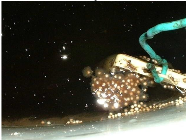
Figura 6: Colônias de bactérias autotróficas aderidas a pérolas de isopor
